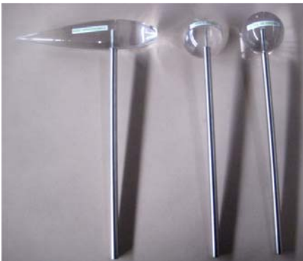
Fig. 3 - Set modelli di prova: modelli di resistenza, profili alari, lamina piana
