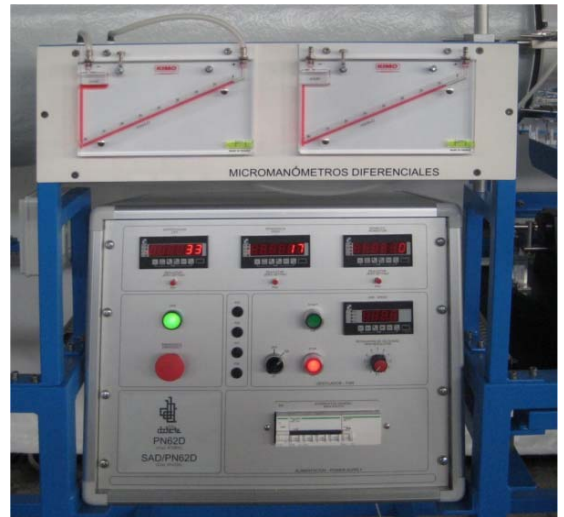
Fig. 1 Particolare del quadro elettrico di comando con SAD/PN62D (cod.914334) e dei micromanometri differenziali
