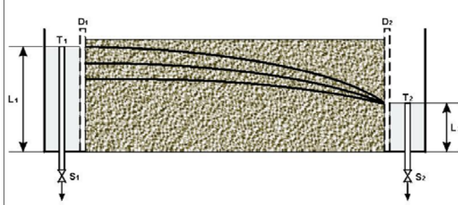
Fig. 2 - Trincea in falda freatica
